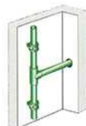
ب : سوراخ درون دیواره به اندازه کافی بزرگ باشد تا بصورت یک بست متحرک عمل کند
